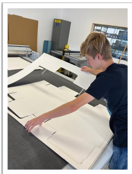
Vorab am PC alles genau eingestellt, um dem Plotter genau zu sagen, wo eine Faltnie sein muss und wo ausgeschnitten wird.
